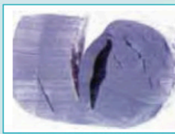
由于爆炸分解而导致O型密封圈损坏
